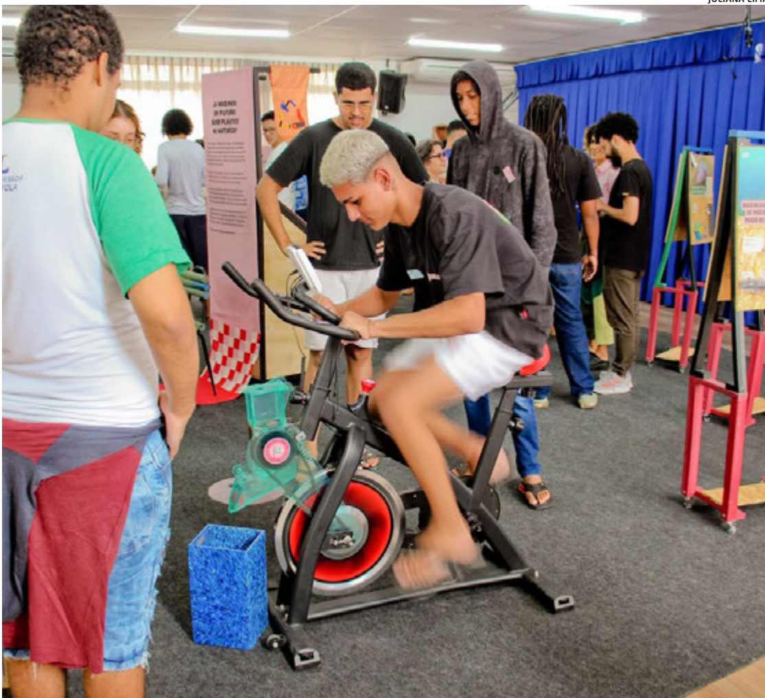
A bicicleta trituradora transforma pedaladas em tampas de plástico trituradas para reciclagem
